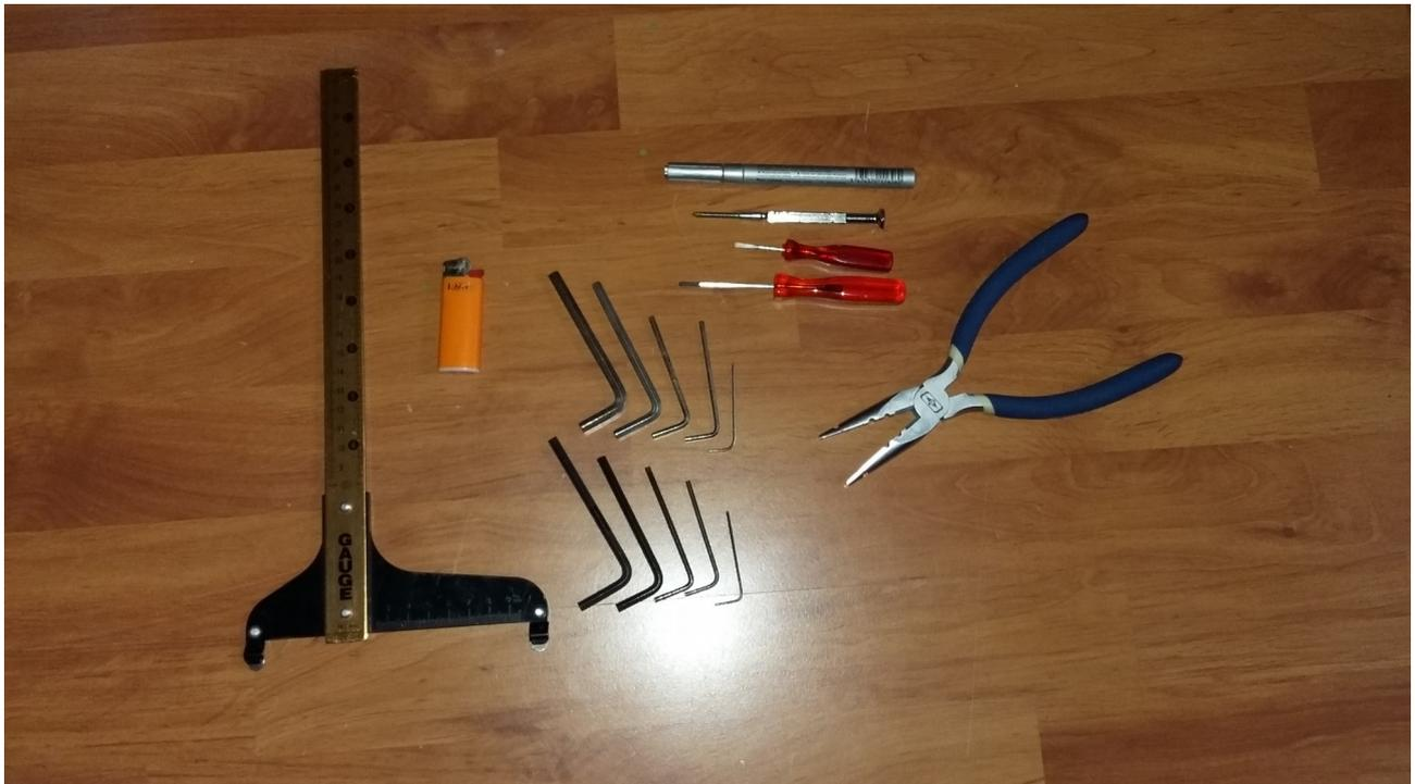
*Illustration 23 : le contenu de la trousse à outil : equerre, briquet, clés Allen, stylo marqueur, tournevis plats et cruciforme, pince à nocksets.*
